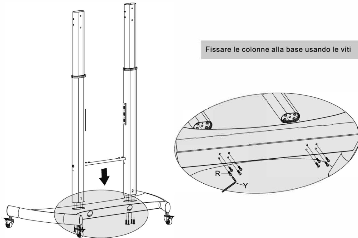
Fissare le colonne alla base usando le viti
