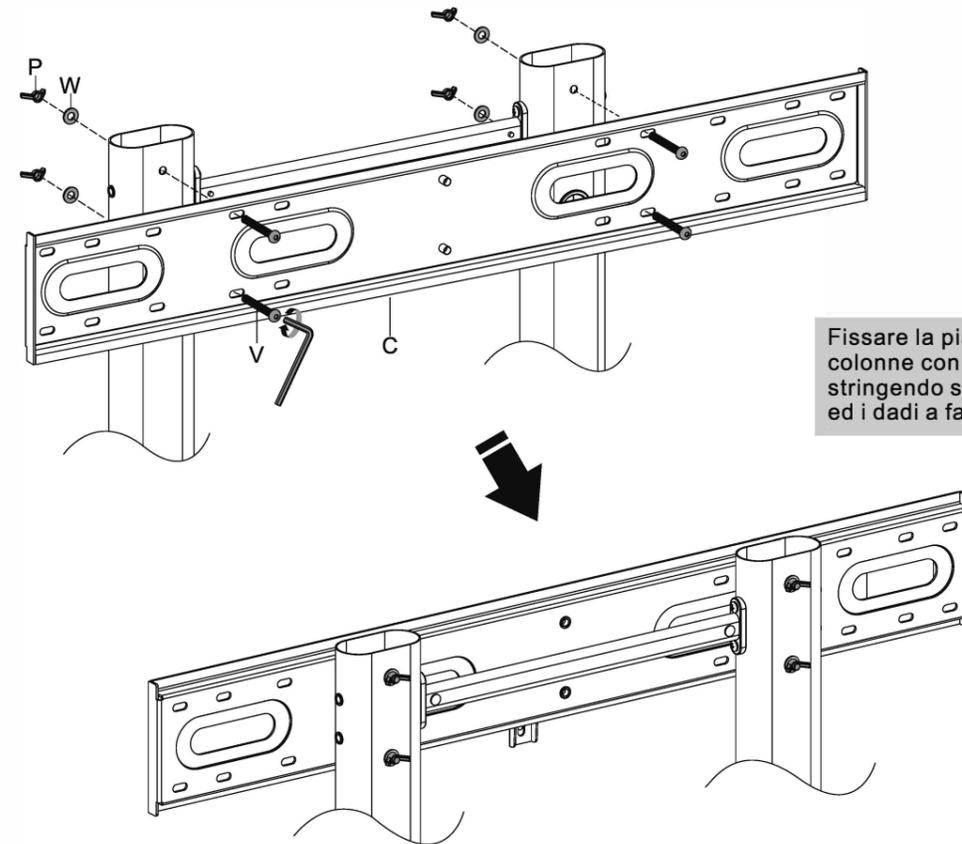
Fissare la piastra universale alle colonne con le viti corrispondenti, stringendo saldamente le rondelle ed i dadi a farfalla.
