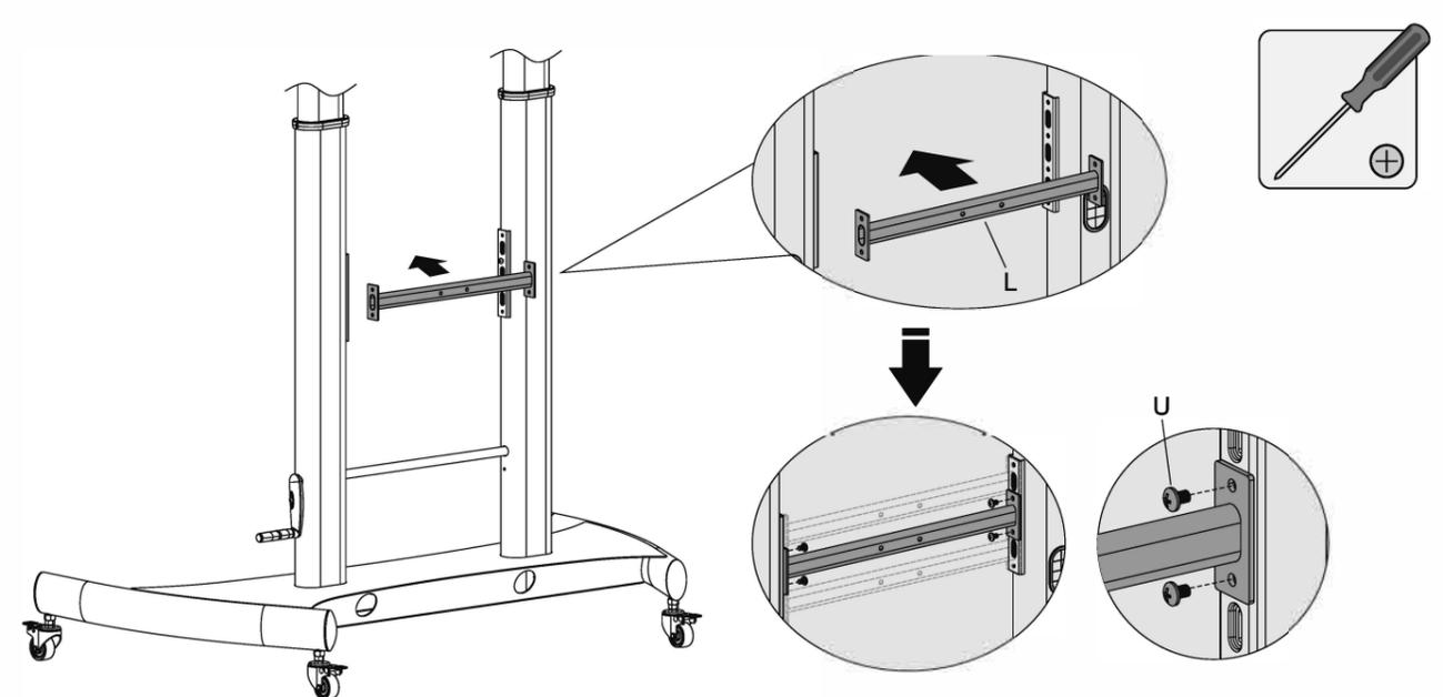
Fissare la barra di supporto alle colonne all'altezza desiderata usando le viti apposite.
