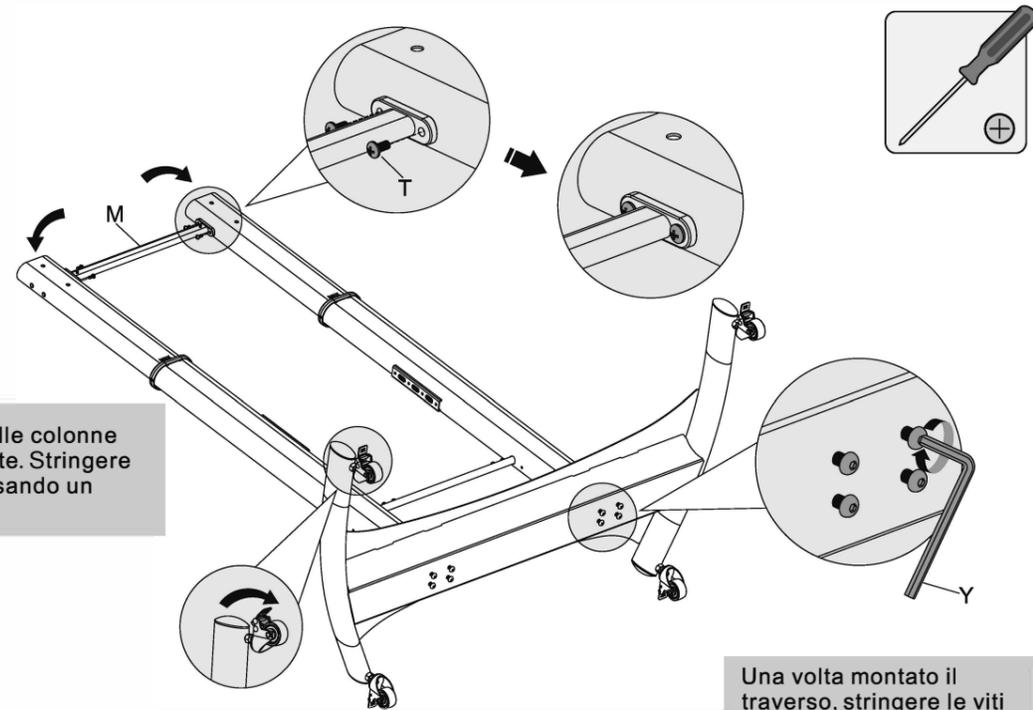
Fissare il traverso alle colonne usando le viti indicate. Stringere le viti saldamente usando un cacciavite a stella.
