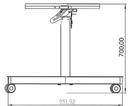
Altezza minima / Configurazione del supporto: 700 mm
