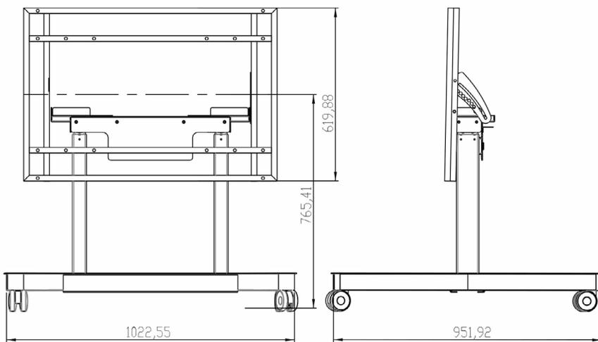
Altezza minima / Configurazione del carrello: 765 mm
