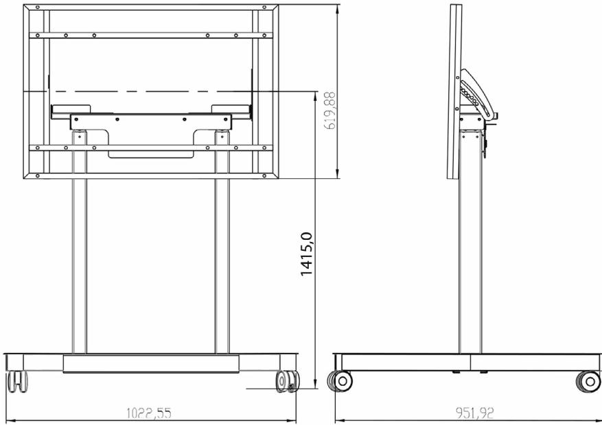
Altezza massima / Configurazione del carrello: 1415 mm
