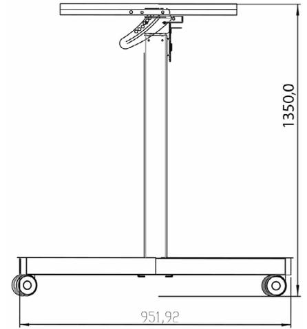
Altezza massima / Configurazione del supporto: 1350 mm
